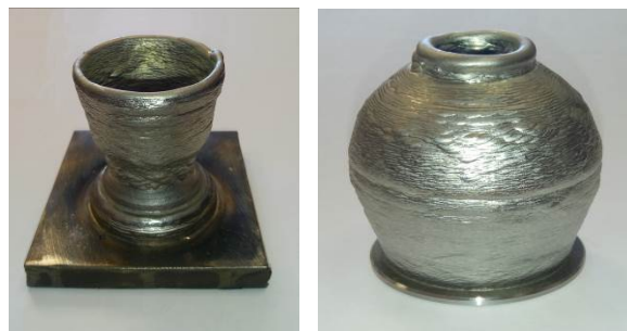
Рис. 4. Образцы, полученные способом электронно-лучевого выращивания (диаметр основания 50 мм, высота 60 мм)
