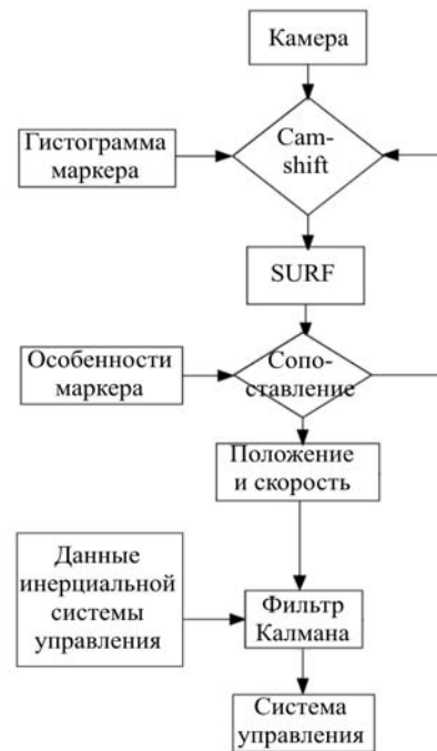
Рис. 3. Блок-схема алгоритма с применением компьютерного зрения, обеспечивающего автономную посадку БПЛА
