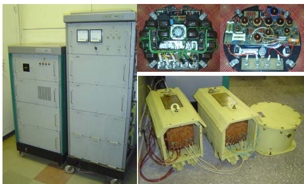
Рис. 9. Система электропитания телеуправляемого подводного аппарата «СЭП-30»
