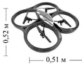
Рис. 1. Квадрокоптер Parrot AR.Drone
