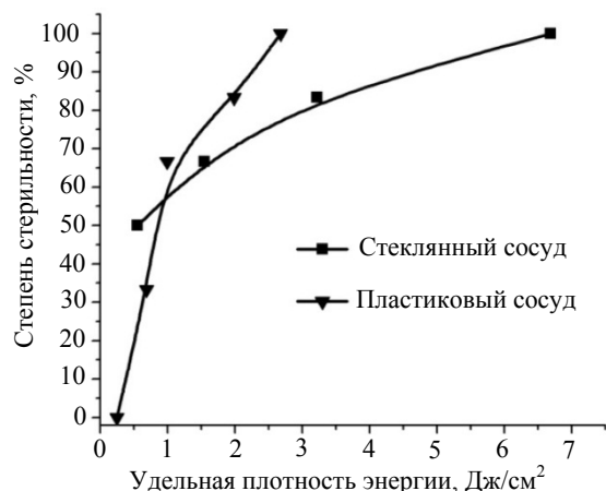
Рис. 4. Степень стерилизации в зависимости от общей плотности энергии, вводимой в сосуд. Ток пучка 5 мА, энергия пучка 3–6 кэВ, число сеансов 1–18, длительность сеанса 5 с, перерыв между сеансами 20 с
