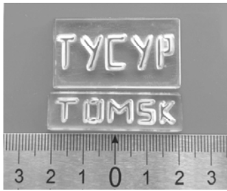
Рис. 9. Результат фрезеровки кварцевой пластины электронным лучом
