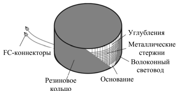
Рис. 3. Схема волоконно-оптического сенсора № 2
