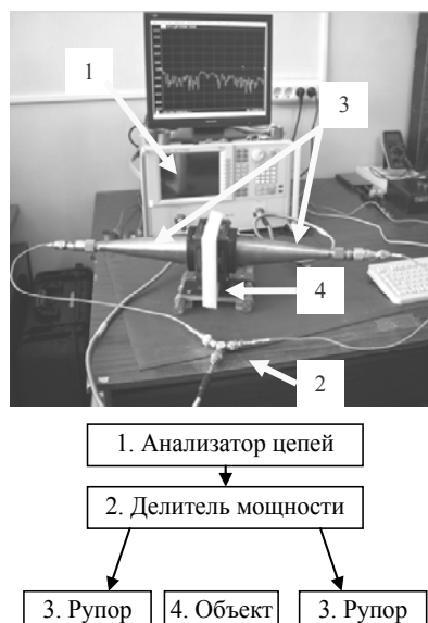
Рис. 1. Макет микроволнового интерференционного микроскопа
