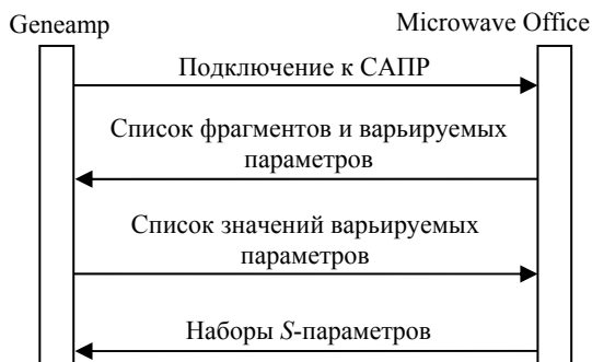
Рис. 3. Схема взаимодействия программ Geneamp и Microwave Office
