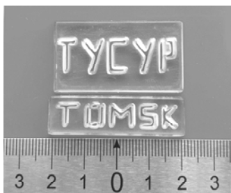
Рис. 9. Результат фрезеровки кварцевой пластины электронным лучом
