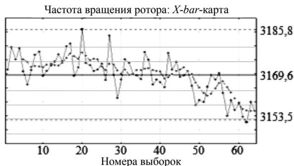
Рис. 2. X-карта частоты вращения ротора с границами  $\pm 3\sigma$
