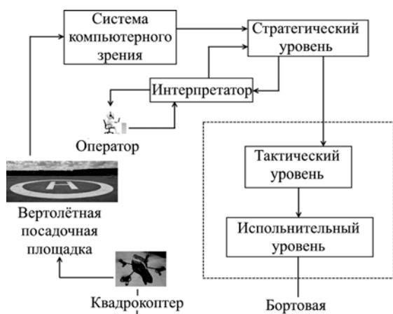
Рис. 2. Структурная схема системы управления квадрокоптером
