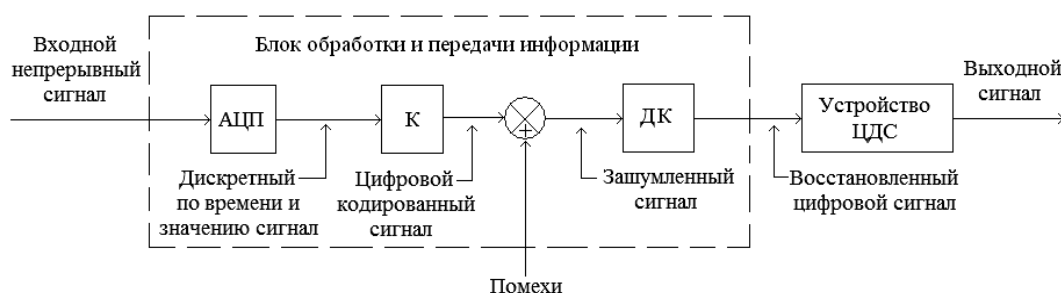
Рис. 1. Структурная схема системы ЦДС
