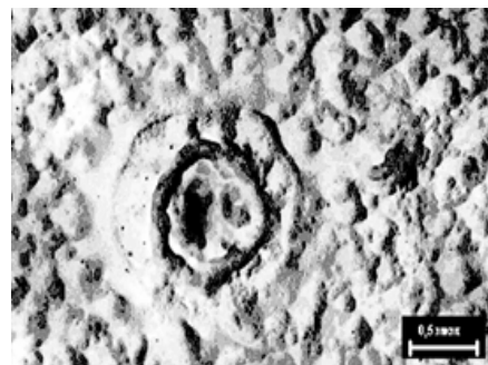
Рис. 1. Микрофотографии канала пробоя (а) и формованного канала (б)
