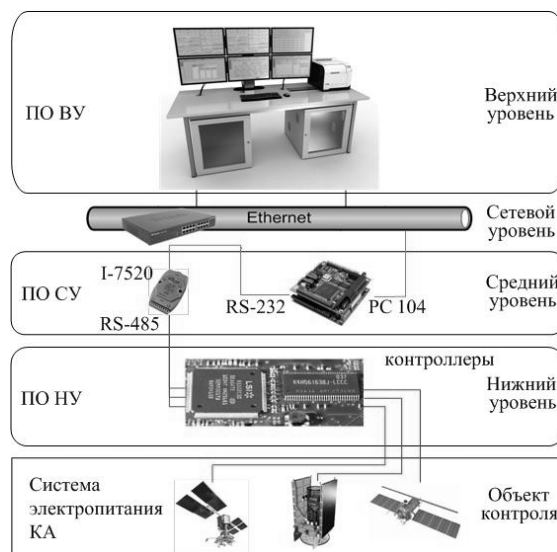
Рис. 4. Структурная схема программного обеспечения АРМ ЭПА СЭП КА
