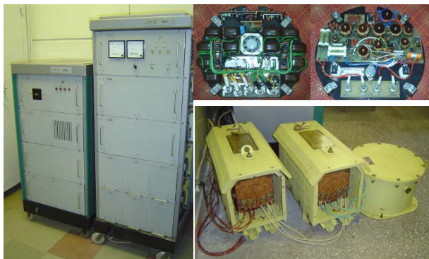
Рис. 9. Система электропитания телеуправляемого подводного аппарата «СЭП-30»
