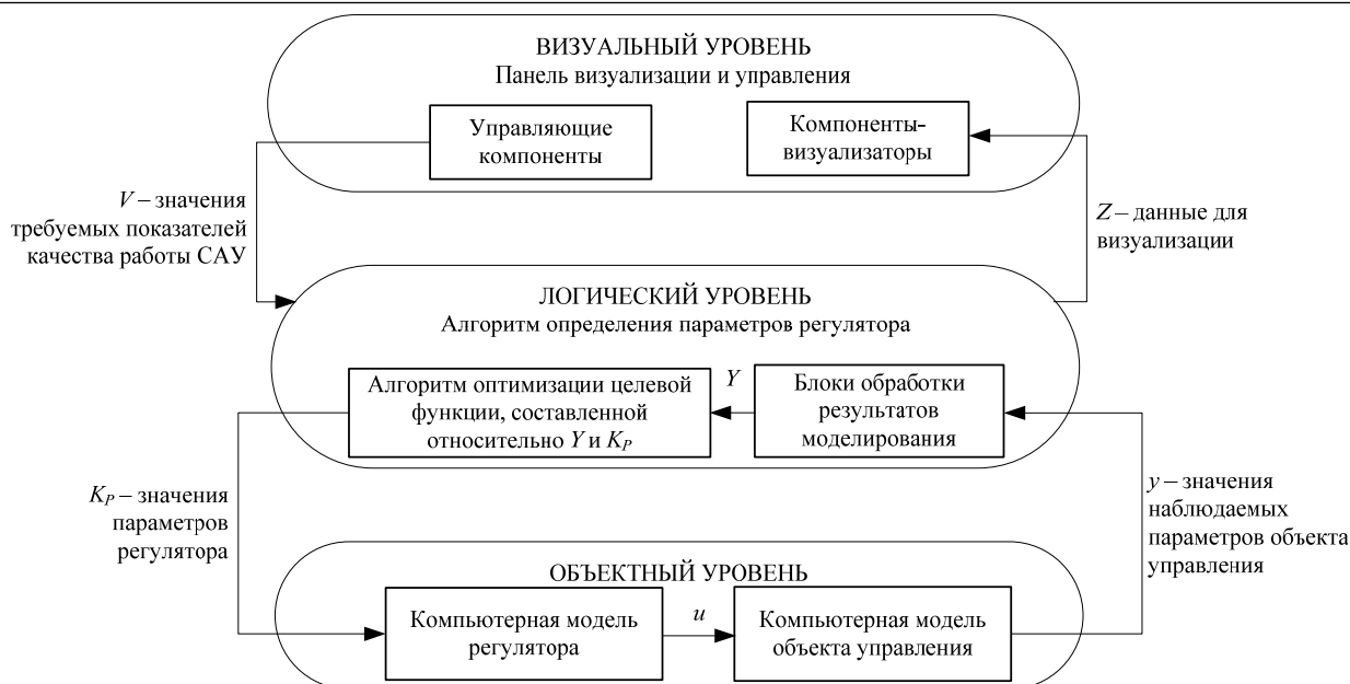
Рис. 1. Структура многоуровневой компьютерной модели для определения значений параметров регулятора
