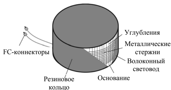
Рис. 3. Схема волоконно-оптического сенсора № 2
