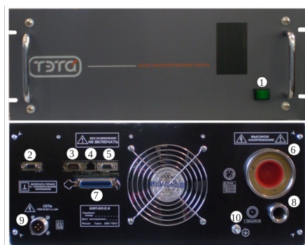
Рис. 2. Блок электропитания и управления системой формирования пучка: 1 – кнопка включения; 2 – управление ИВН, 3 – резервный разъем (не используется); 4 – Ethernet; 5 – связь с управляющим компьютером; 6 – питание электронной пушки; 7 – управление
