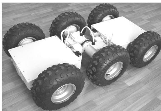
Рис. 1. Шестиколёсный робот на мобильной робототехнической платформе МРП-100
