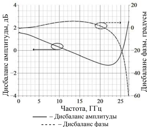
Рис. 6. Зависимость дисбаланса амплитуды и фазы трансформатора от частоты
