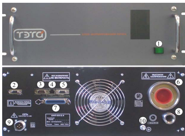
Рис. 2. Блок электропитания и управления системой формирования пучка: 1 – кнопка включения; 2 – управление ИВН, 3 – резервный разъем (не используется); 4 – Ethernet; 5 – связь с управляющим компьютером; 6 – питание электронной пушки; 7 – управление электронным лучом; 8 – 60 кВ с ИВН; 9 – сеть 220 В; 10 – заземление
