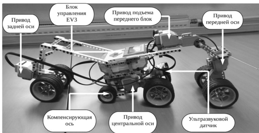
Рис. 5. Опытный образец робота МРП-100, сконструированный на основе набора Mindstorms Lego EV3
