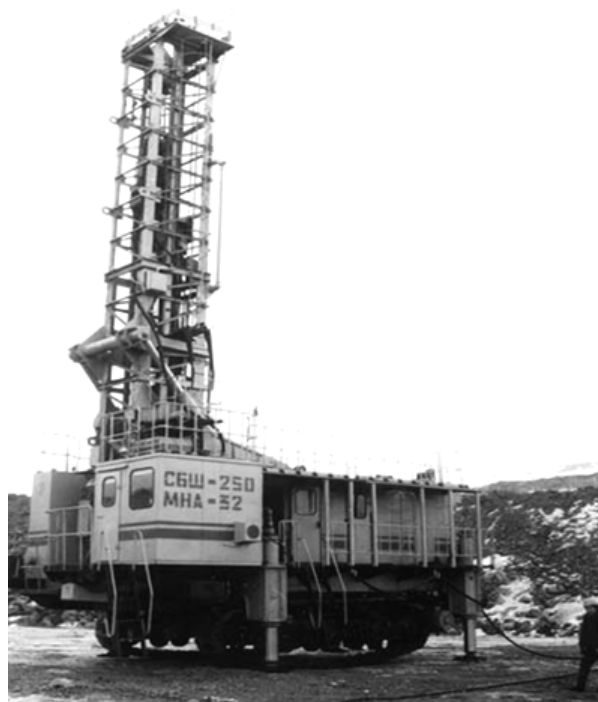
Рис. 1. Буровой станок вертикального бурения СБШ-250МНА
