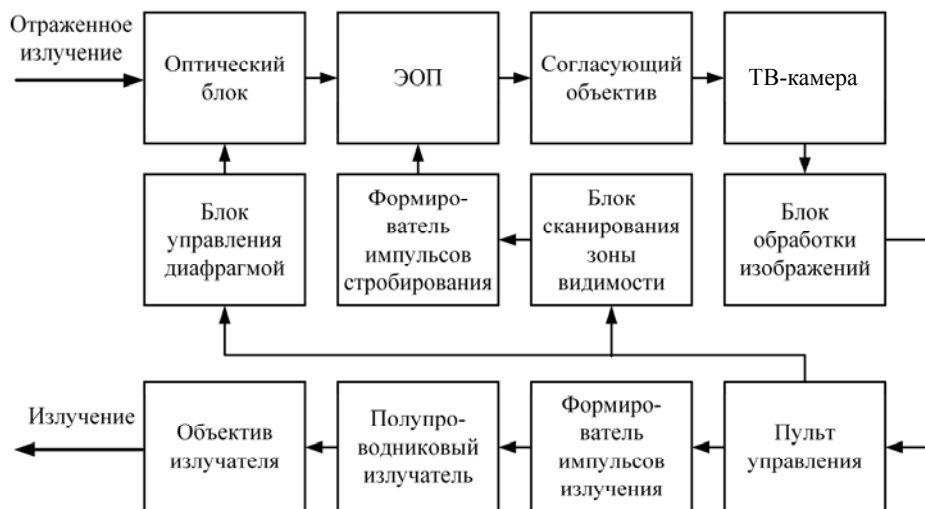
Рис. 1. Структурная схема активно-импульсной телевизионно-вычислительной системы
