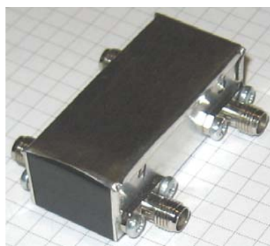
Рис. 4. Направленный ответитель в сборе
