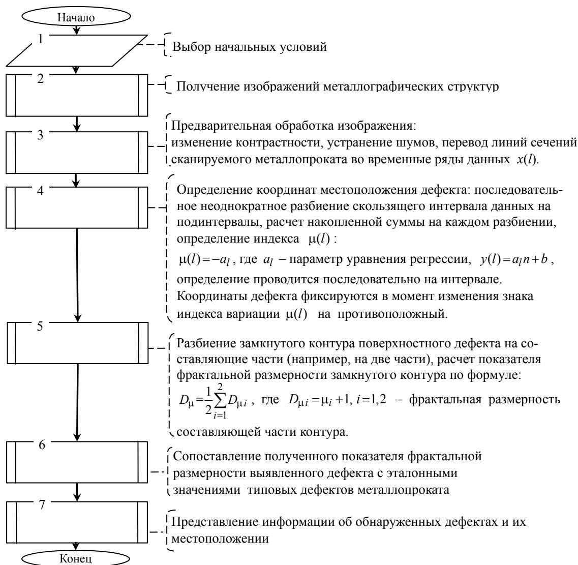
Рис. 2. Блок-схема способа оценивания качества поверхности металлопроката
