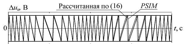
Рис. 8. Рассчитанные по (16) и полученный при моделировании проинтегрированный сигнал рассогласования по напряжению
