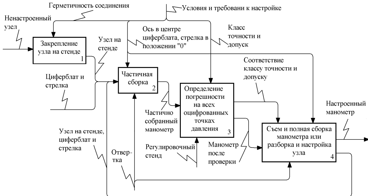
Рис. 2. Функциональная схема цикла настройки манометра
