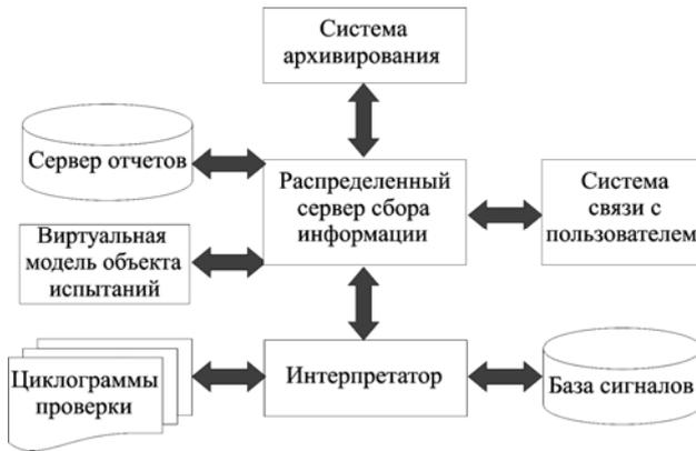
Система «Лотос» дает возможность унифицировать программные модули и использовать их в других проектах, таким образом, упрощая процесс разработки и автоматизируя испытания различных видов приборов.
