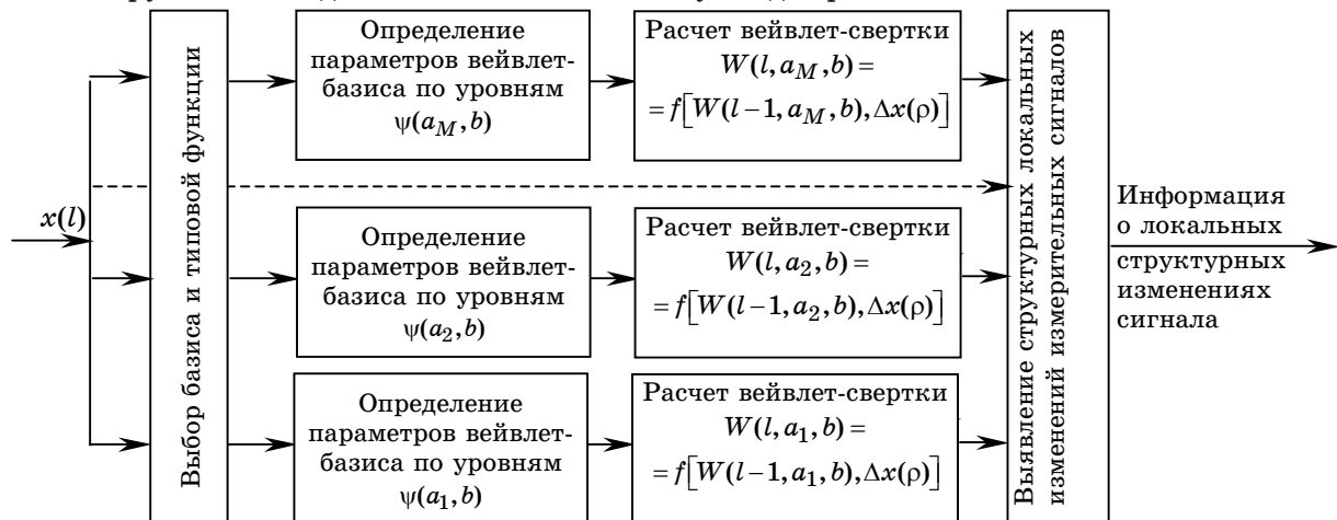
Рис. 2. Многоканальная структура распараллеленного алгоритма вейвлет-анализа измерительных сигналов: x(l) – фактические значения анализируемого сигнала в l – текущий момент времени; \psi – тип вейвлет-базиса; W(l, a, b) – значения вейвлет-свертки; a_1, a_2, \dots, a_M – уровни детализации сигнала; M – заданное число уровней детализации сигнала; b – параметр смещения по оси времени
