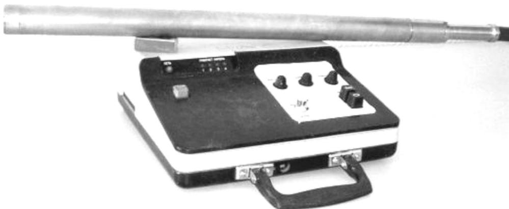
Рис. 2. Внешний вид радиационно-стойкой видеокамеры и блока управления
