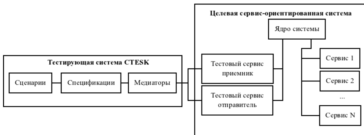
Рис. 1. Структурная схема тестирования сервис-ориентированной системы
