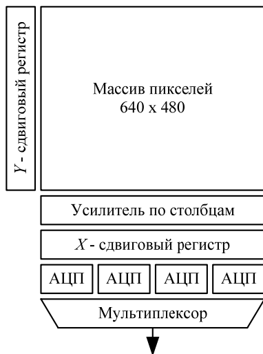
Рис. 1. Структурная схема видеосенсора LUPA-300
