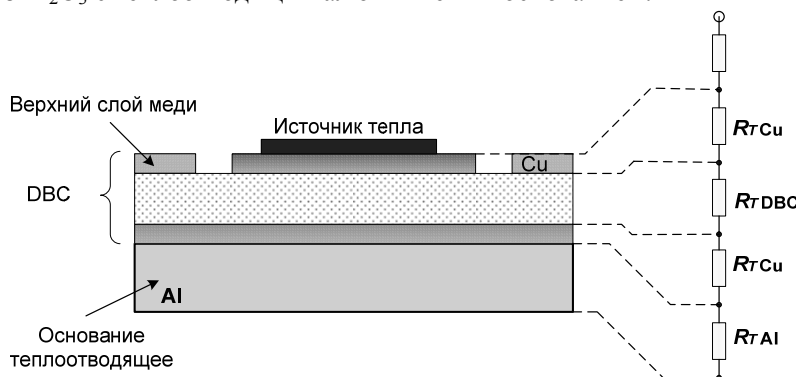
Рис. 12. Платы из двухсторонней DBC-керамики и эквивалентная схема теплового сопротивления
