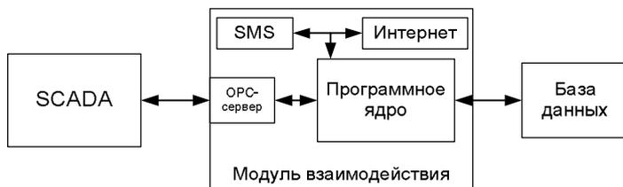
Рис. 1. Структурная схема системы взаимодействия с мобильным персоналом
