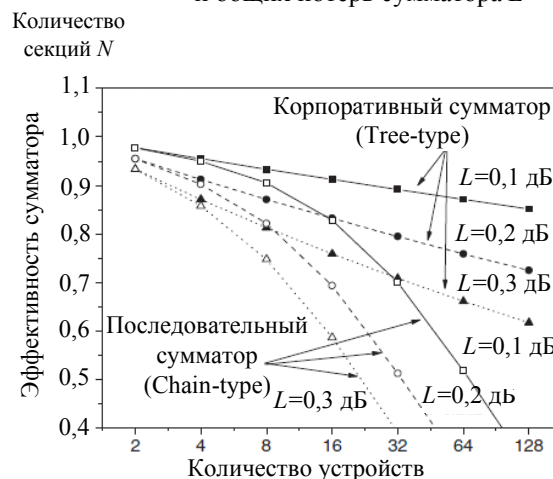
Рис. 11. КПД корпоративного сумматора в зависимости от количества суммируемых транзисторов N и общих потерь сумматора L
