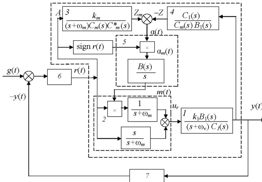
Рис. 2. Структурная схема самонастраивающейся САУ объектами управления с изменяющейся постоянной времени
