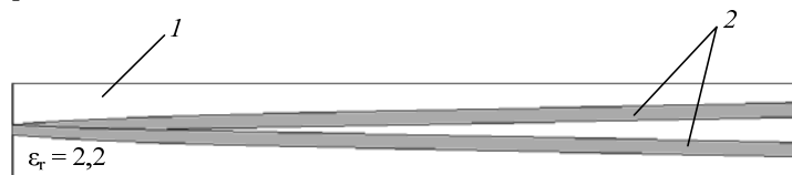
Рис. 9. Топология СПЛ: 1 – диэлектрическое заполнение; 2 – СПЛ
