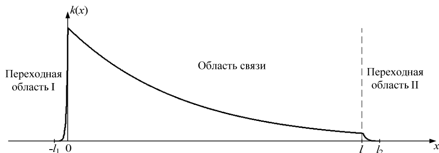
Рис. 7. Зависимость аппроксимации коэффициента связи от текущей координаты вдоль области связи
