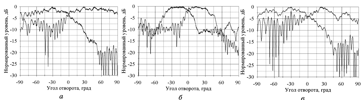
Рис. 3. Диаграммы направленности: а – логопериодических; б – рупорных и в – спиральных антенн пеленгатора, расположенного в первой точке приема
