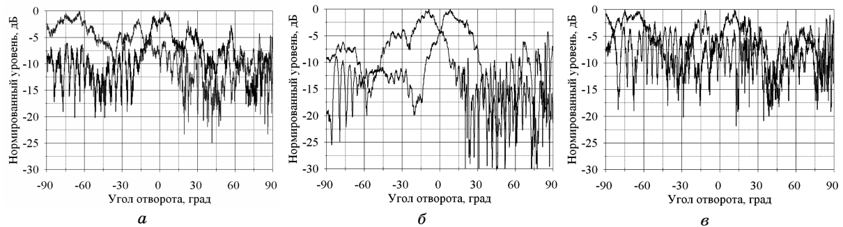
Рис. 5. Диаграммы направленности: а – логопериодических; б – рупорных и в – спиральных антенн пеленгатора, расположенного в третьей точке приема
