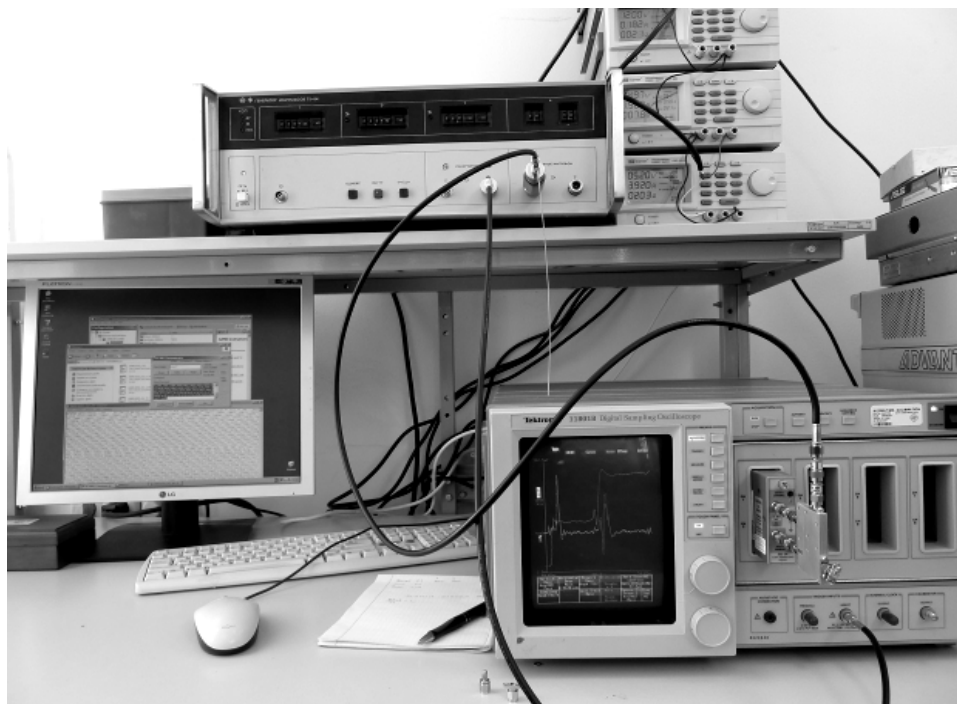
Рис. 3. Экспериментальная установка для исследования характеристик нелинейности методом нелинейной рефлектометрии
