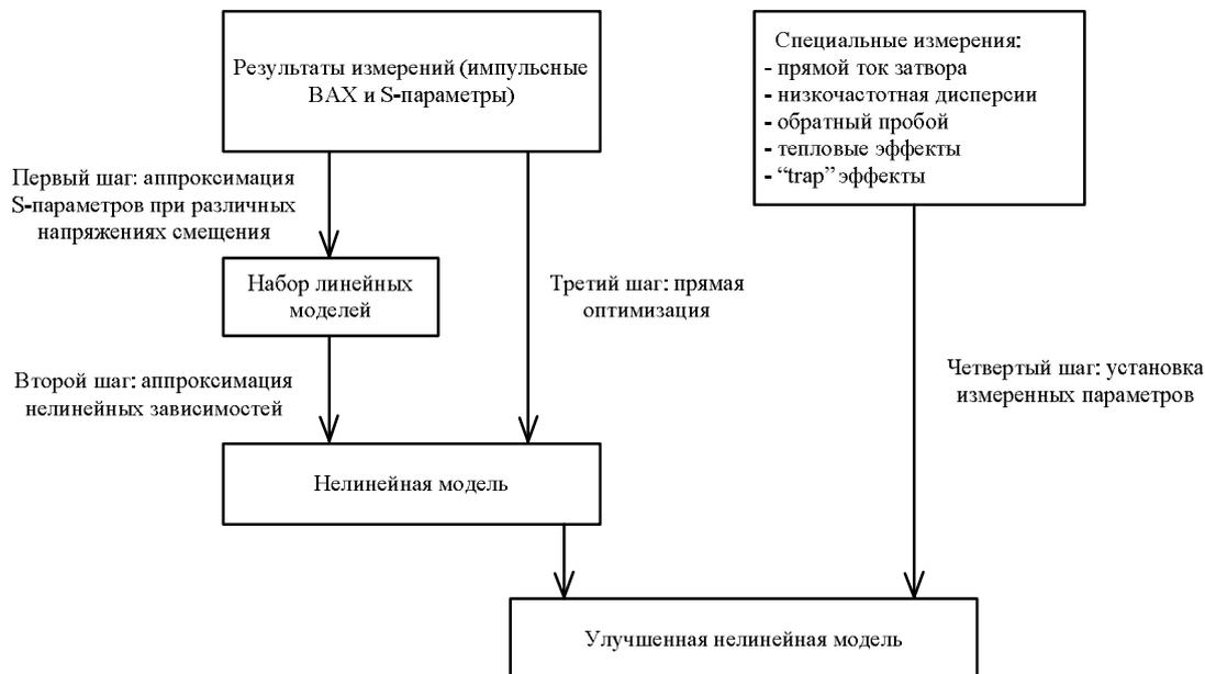
Рис. 2. Методика экстракции формальных нелинейных моделей СВЧ-транзисторов
