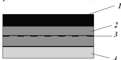
Рис. 1. Структура кислородно-цинкового аккумулятора с дополнительным электродом:
