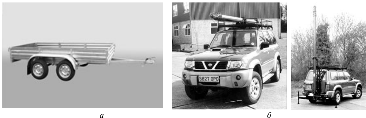
Рис. 2. Узлы мобильного ретранслятора: а – бортовой двухосный прицеп МЗСА 817732.001-05; б – телескопическая мачта WT10-6 в сложенном и рабочем состоянии
