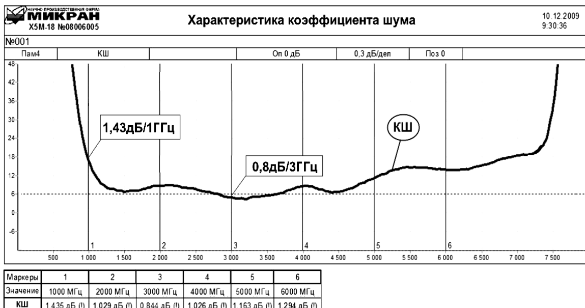
в Рис. 3 (продолжение). Измеренные частотные характеристики усилителя: в – коэффициент шума после настройки платы
