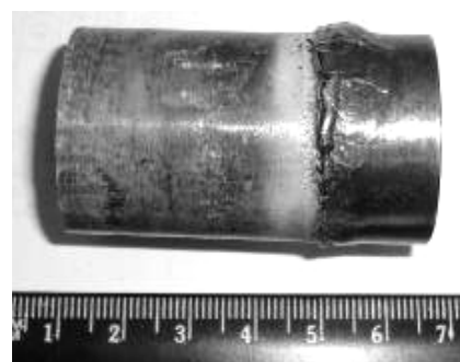
Рис. 3. Соединение керамики на основе талько-шамотной смеси с титаном ВТ-5
