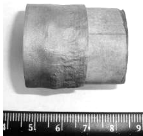
Рис. 2. Соединение керамики ВК94-1 и алюминия (слева – алюминий, справа керамика)
