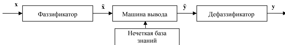
Рис. 1. Типовая структура системы нечеткого логического вывода
