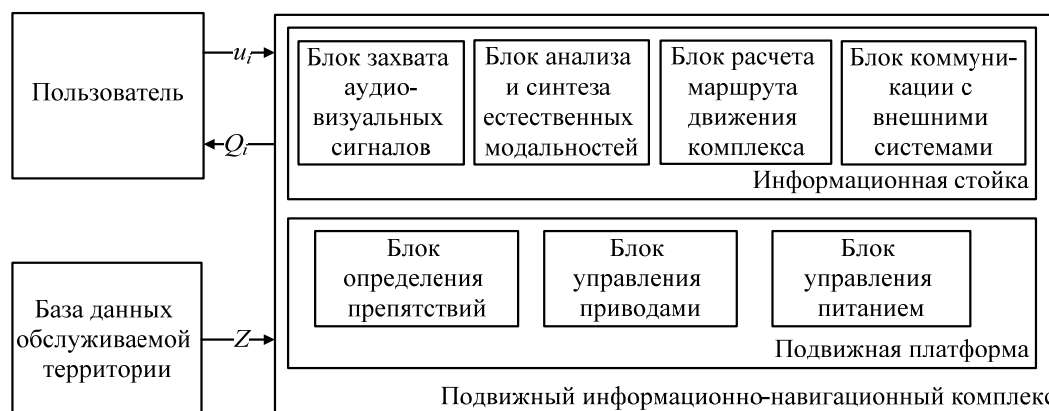
Рис. 1. Структурная модель подвижного информационно-навигационного комплекса
