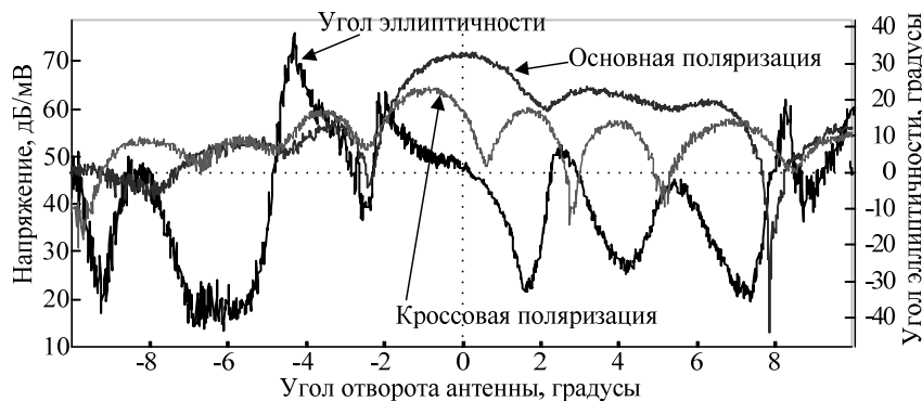
Рис. 4. Огибающие регистрируемых сигналов за 1 оборот антенны РЛС
