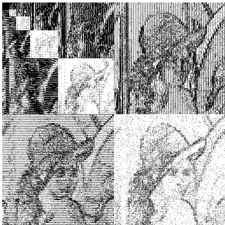
Рис. 2. Расположение квантованных элементов данных после 5-уровневого ДКЛП полутонового изображения «Lenna»
