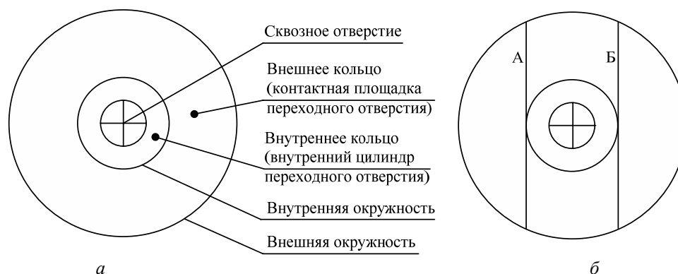
Рис. 1. Элементы контактной площадки переходного отверстия (а) и аппроксимация кольца (б)
