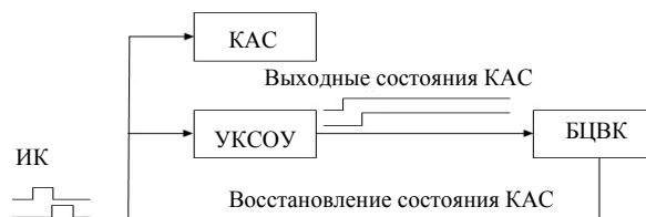
Рис. 2. Схема взаимодействия устройства контроля состояния объекта управления и БЦВК
