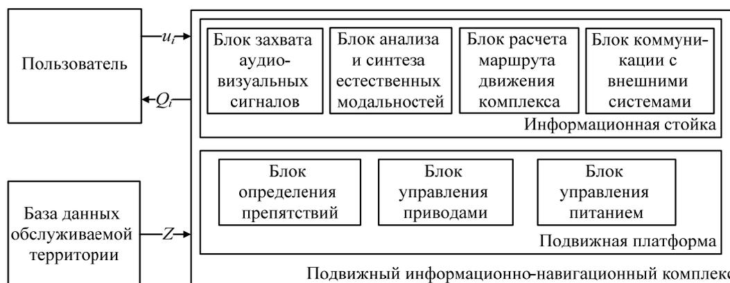
Рис. 1. Структурная модель подвижного информационно-навигационного комплекса
