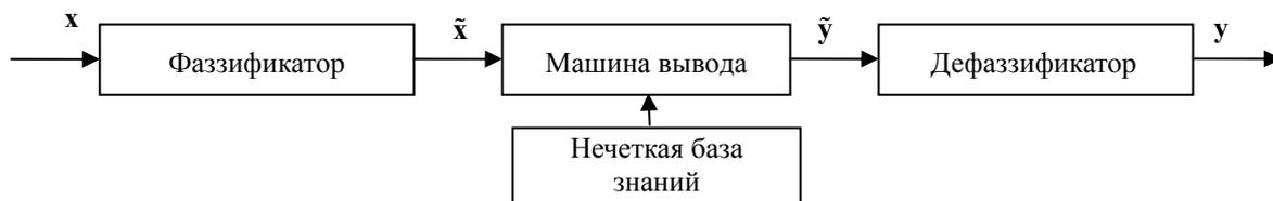
Рис. 1. Типовая структура системы нечеткого логического вывода
