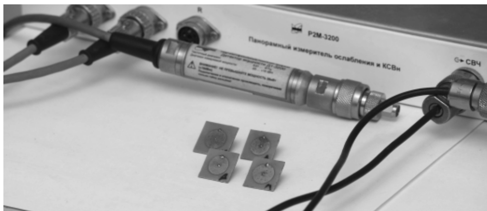
Рис. 2. Разработанные макеты аппликационных антенн на фоне скалярного измерителя ослабления и КСВн P2M-3200, на котором проводились измерения
