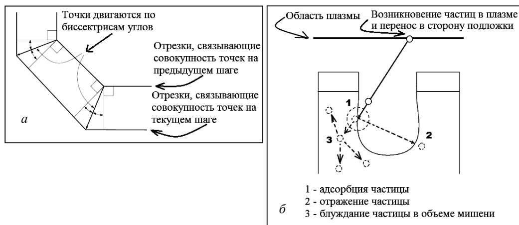
Рис. 1. Аппроксимация динамики поверхности структуры в модели струны (а); события, которые могут произойти с частицей плазмы при моделировании с помощью ММК (б)
