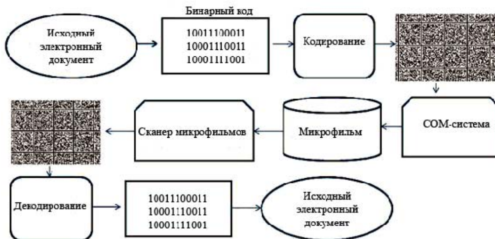
Рис. 1. Схема сохранения бинарной информации на микрофильме
